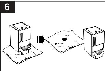
6. Očistite višak mastila sa mlažnicama tako što ćete nekoliko puta blago prisloniti papirnu maramicu na taj deo kertridža. Postavite ga u printer i pokrenite "head cleaning" proces.
