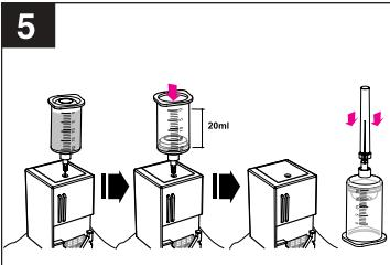
5. Tolja be a befecskendező tűt körülbelül 5 mm-re, majd lassan fecskendezzen be 20 ml (1 üveg) tintát tintatartó dugattyújának nyomásával 30 másodpercen keresztül. Majd húzza ki a tintavezetőt.
